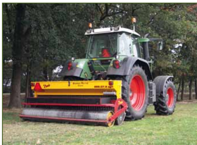
Sečí stroj holandské výroby Vredo může mít řadu typů - záběr až do cca 6 m, a také různé válce - rýhované, Cambridgeské, prisma-tické, zde je s válcem hladkým
